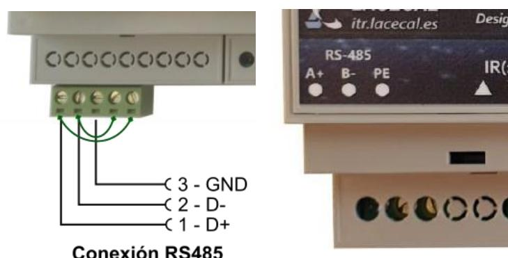
Dependiendo del modelo la denominación de las conexiones de salida puede variar, verificándose las equivalencias de la siguiente tabla:
